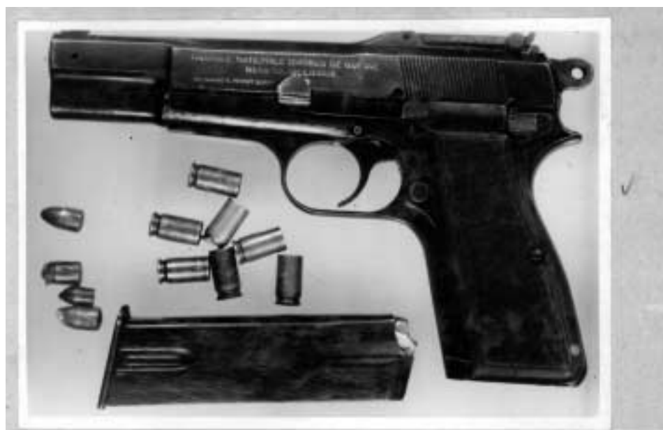
Zbraň s níž spáchal Bohumil S i x t a dvojnásobnou vraždu a pokus vraždy na orgánech státní bezpečnosti. Jde o belgickou armádní pistolí zn. FN, výrobní číslo 62914, ráže 9 m/m, pro náboje vzor 06 s příslušným zásobníkem na 15 nábojů.
