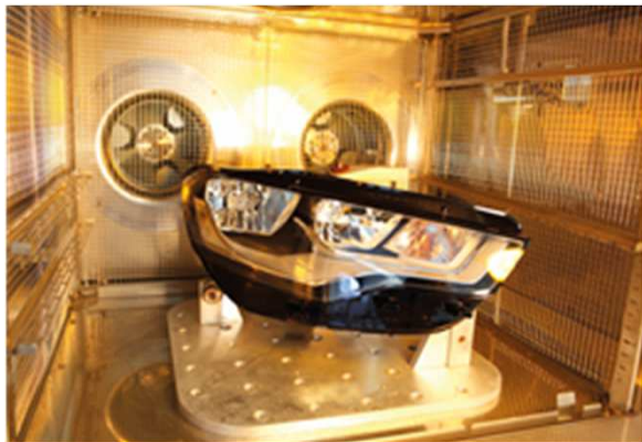
24 hod. tepelný zátěžový test
