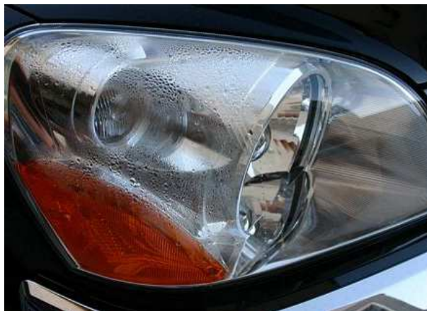
Srážení vody uvnitř světlometu
