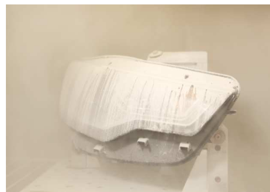
Test proti vniknutí prachu
