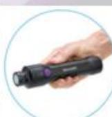
**NIRLAB** Identifikace a **rychlá kvantitativní analýza drog** v terénu (obsah THC/TBD v marihaně, obsah heroinu, kokainu, MDMA, amfetaminu a methamfetaminu v droze). Nová unikátní technologie NIR spektrometrie využívající principů umělé inteligence. Výsledek do 1 minuty po stisknutí tlačítka, velmi jednoduchá obsluha, sdílení výsledků v zabezpečeném cloudu, software v češtině.
