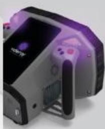
**Videray PX1** Ruční dutinový rentgen (detektor zpětného odrazu). Nová generace zařízení pro vyhledávání drog, výbušnin, balíků bankovek apod. 140 kV technologie, patentovaný detektor o velké ploše, velmi snadná obsluha. Schopnost zobrazit skrz 6 mm oceli, možno kombinovat s Flat panelem (prozařovací zobrazení až skrz 20 mm oceli).
