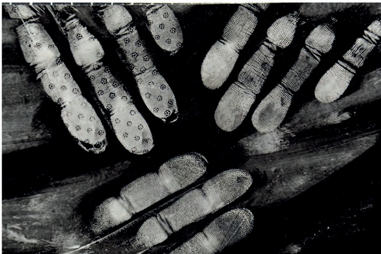
Obr. 7: Porovnání daktyloskopických stop chemicky odolných rukavic Forensic Touch (vlevo nahoře), běžných chirurgických rukavic (dole) a vpravo nahoře holé dlaně (Polycyco)
