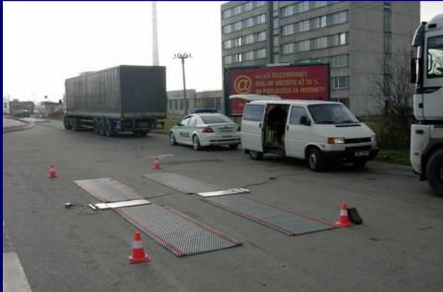
Waage für Achsbelastung
